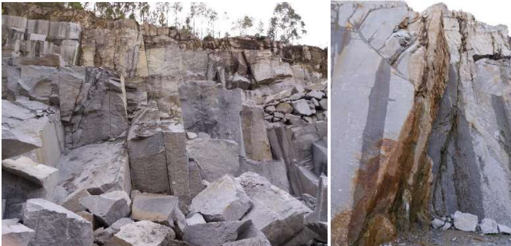
Figura 6. Pormenor das diaclases da família N50°-70°W (esquerda) e zona de falha com diaclasamento oblíquo e meteorização associados (direita).
